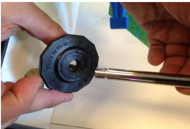
Du côté de la petite tige, insérez la rondelle/plaquette solide ( pas en deux morceaux) et SANS trous de vis
