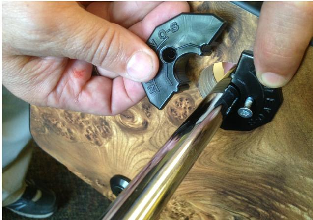
Du côté extérieur du cabinet, placez les plaquettes de plastique (positif et négatif) AVEC trous de vis contre chaque coté de la tige
