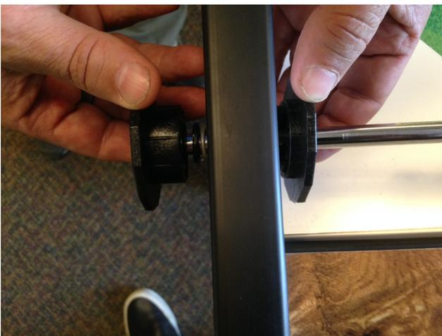
À l'extérieur du boîtier de jeu, placez la plaquette qui à deux trous de vis par dessus le bout de tige pour refermer le tout en alignant les trous de vis avec ceux de la plaquette intérieure
